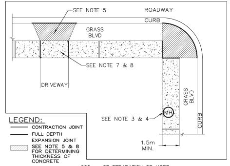
600mm OF SEPARATION OR MORE BETWEEN SIDEWALK AND BACK OF CURB
